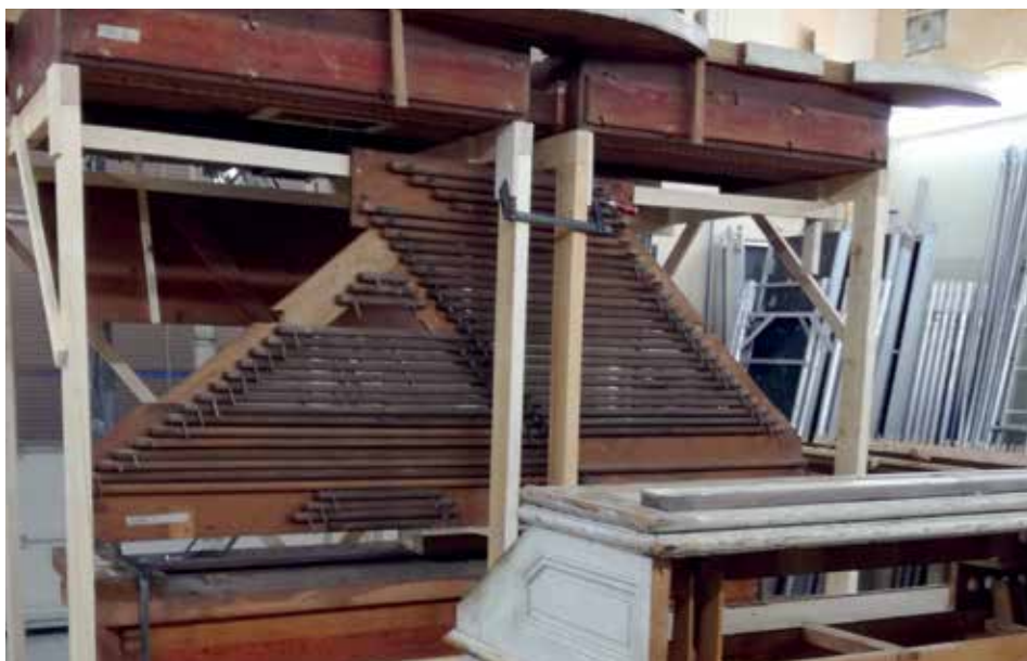
Jasan prikaz krivo postavljenih prijenosnica (Wellenbrett) i nestručno dodavanje čeličnih ručica na desnoj strani, pri čemu su uklonjene originalne drvene
